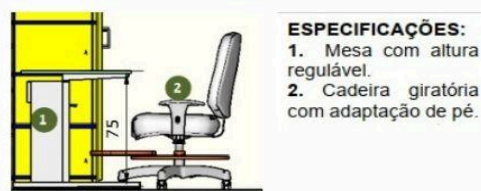
Figura O2 - Mesa com regulagem e cadeira giratória com adaptação para os pés.
