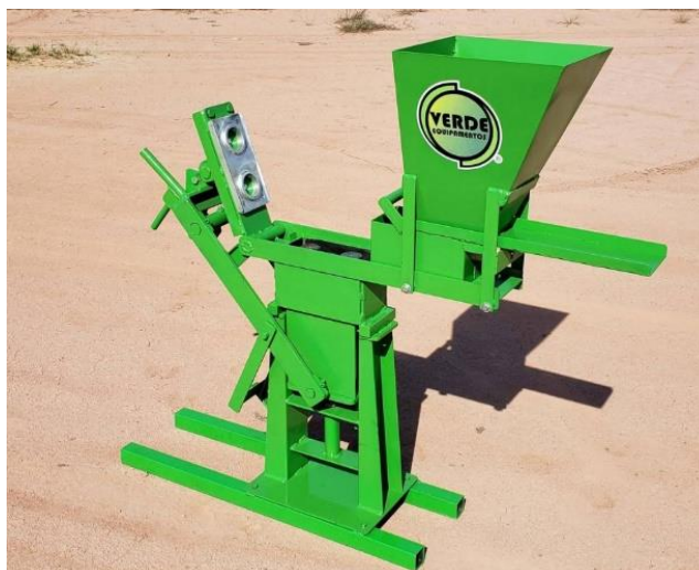
Figura 12 – Prensa manual para fabricação de tijolo solo-cimento.
