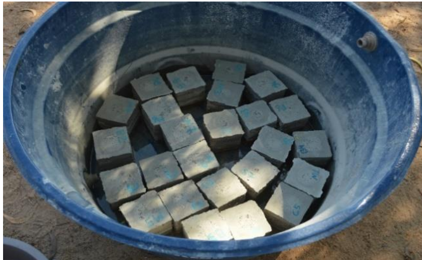
Figura 36 – Corpos de prova imersos em água.
