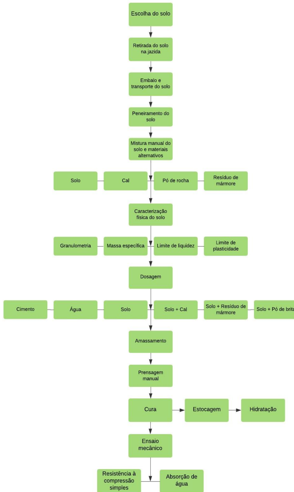
Figura 19 – Fluxograma do processo de produção dos corpos de prova.
