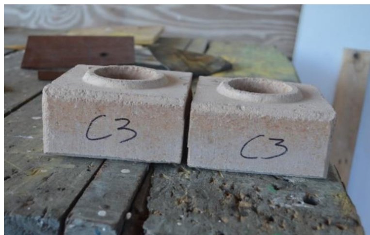
Figura 32 – Tijolo cortado com serra diamantada.
