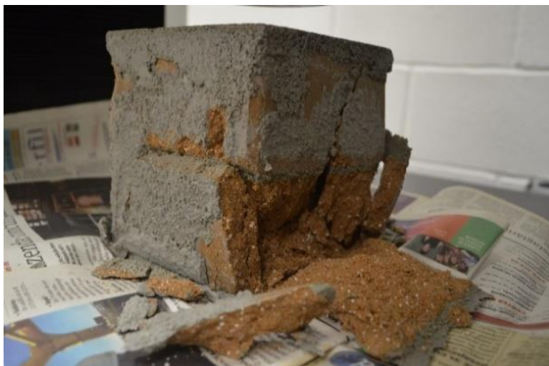
Figura 38 – Corpo de prova após ruptura.
