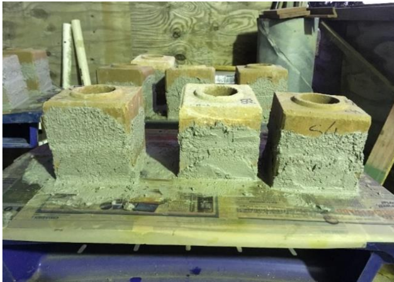
Figura 34 – Tijolos sendo capeados por argamassa.
