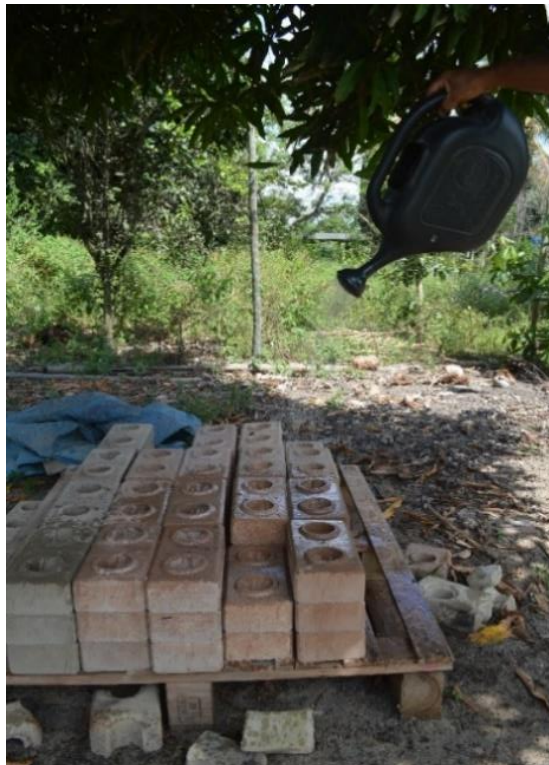
Figura 30 – Hidratação dos tijolos após a fabricação.
