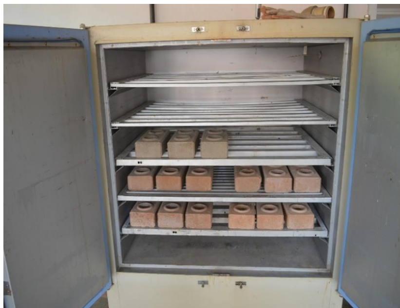
Figura 39 – Amostras submetidas à secagem para o ensaio de absorção de água.
