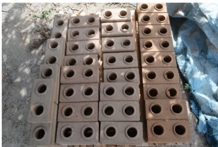
Figura 29 – Tijolos posicionados sobre palete de madeira após fabricação.
