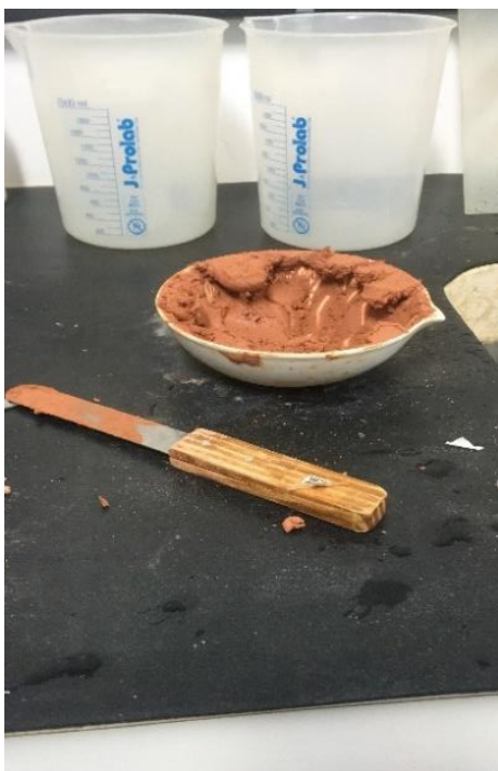
Figura 21 – Pasta formada pela combinação entre solo e água destilada.
