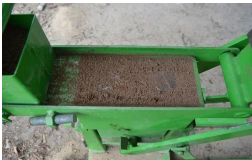
Figura 28 – Amostra adicionada ao molde.
