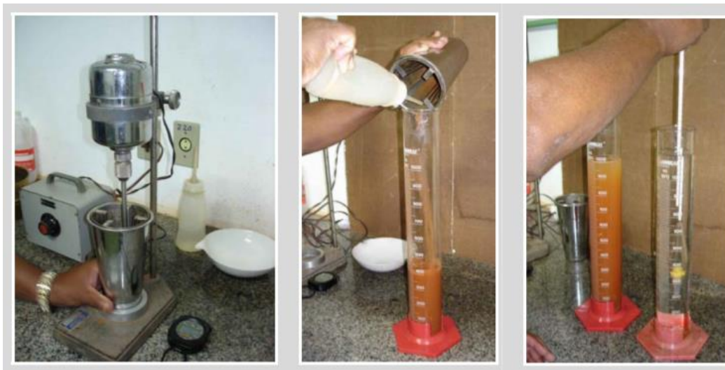
Figura 5 – Ensaio de sedimentação do solo.
