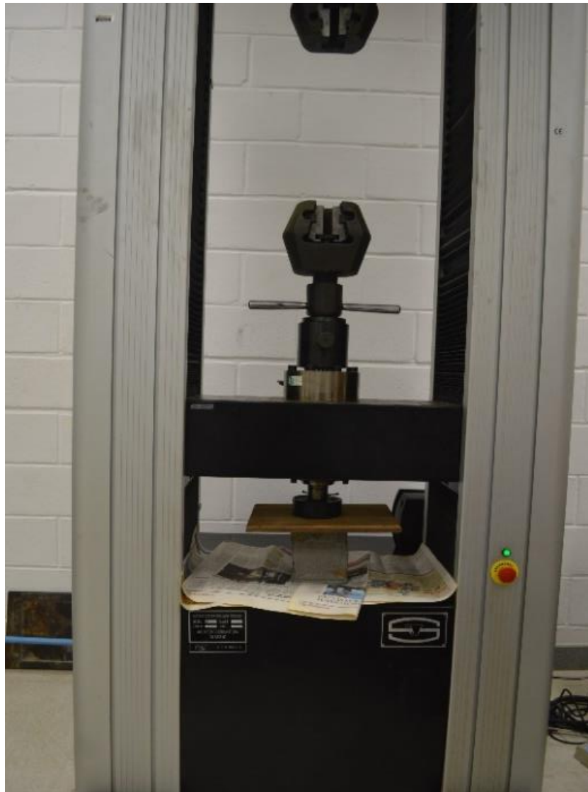
Figura 37 – Máquina de ensaio universal configurada para o ensaio de compressão.
