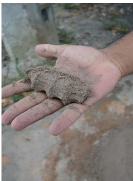
Figura 25 – Verificação de consistência da mistura.
