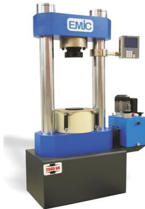
Figura 17 – Máquina de ensaio à compressão simples.
