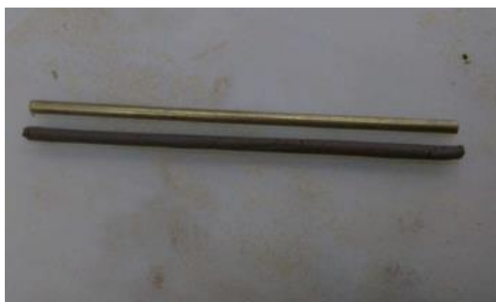
Figura 10 – Ensaio de limite de plasticidade.
