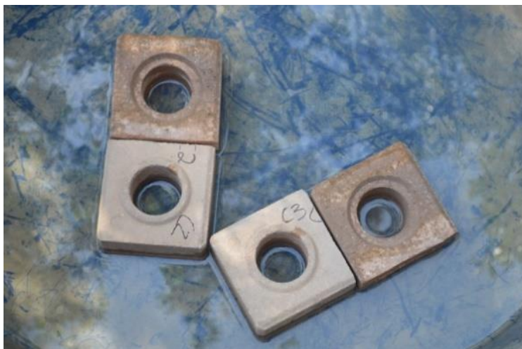
Figura 33 – Preparação do experimento para receber a camada de argamassa.
