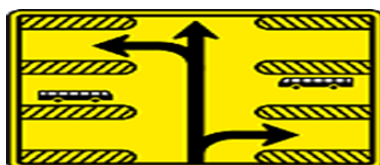
Figura 31 – Placa indicando entradas de ruas ou vias
