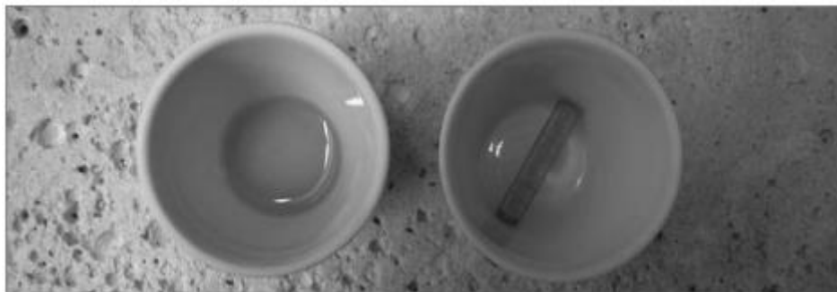
Figura 40 - Cera e resina após aquecimento a 250 ° C (482 ° F)
