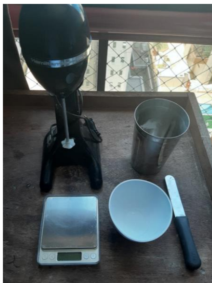
Figura 51 - Equipamentos utilizados para misturar o revestimento.
