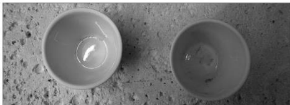
Figura 41 - Cera e resina após aquecimento a 750°C (1382°F).
