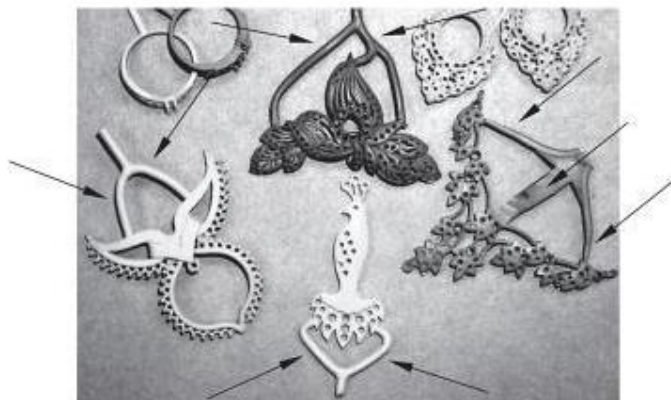
Figura 19: Exemplos de posicionamento de canais de ataque em modelos de fundição.
