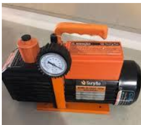
Figura 56 - A imagem mostra a bomba de vácuo da Suryha de 12CFM duplo estágio.
