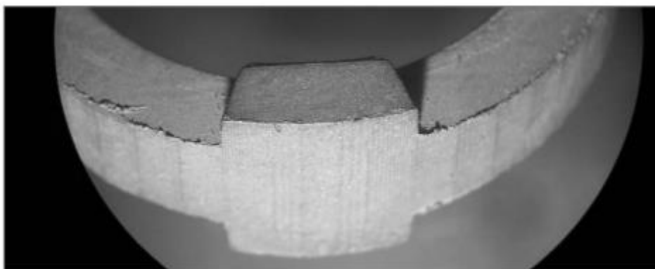
Figura 43 - Ciclo de calcinação com patamar de temperatura de 730°C por 12h.
