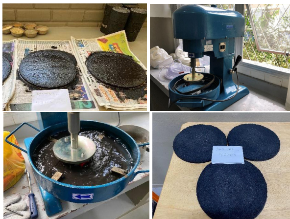
Figura 13.7 — Execução do ensaio para determinação da resistência à abrasão úmida – WTAT
