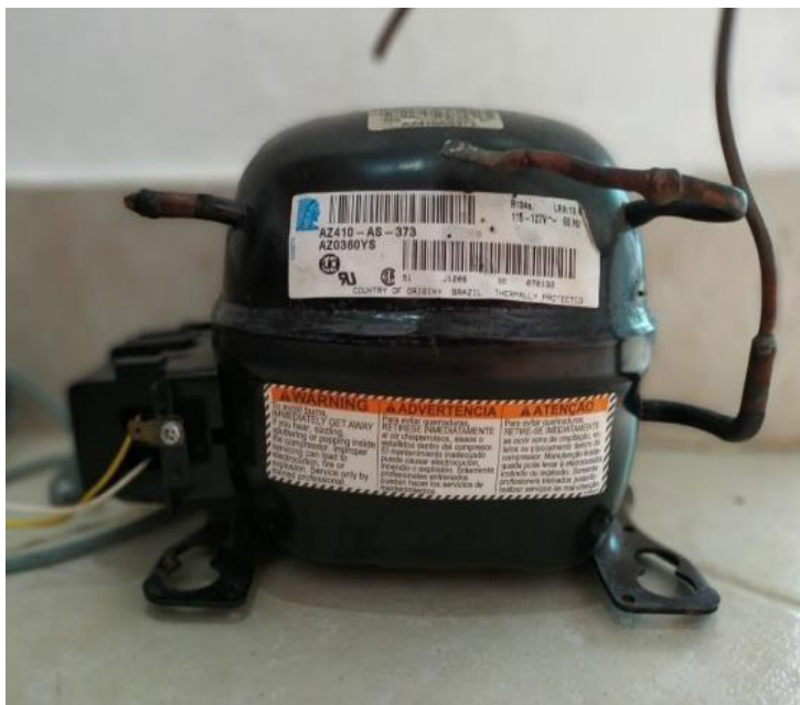
Figura 9.10 — Sistema de compressão
