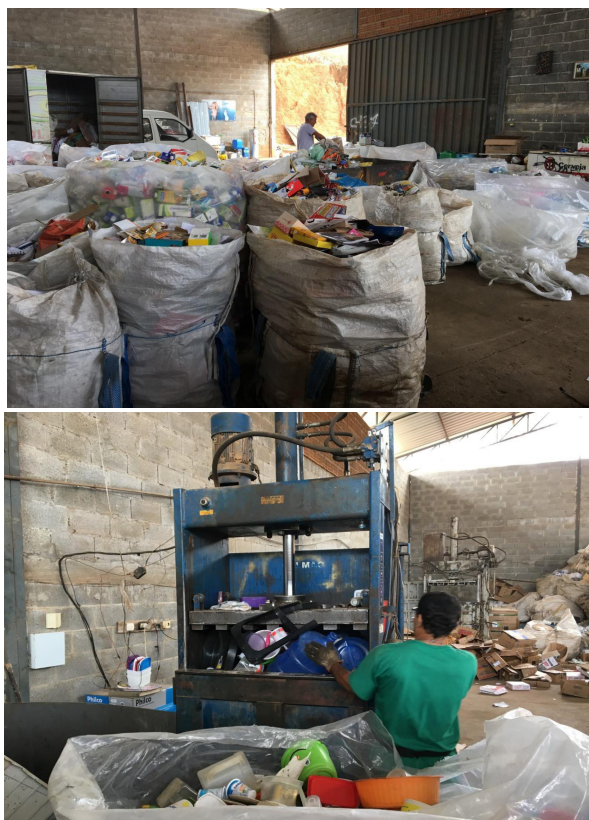
Figura 7.2 — Resíduos segregados em big bags (esq.) e processo de compactação de plástico (dir.)
