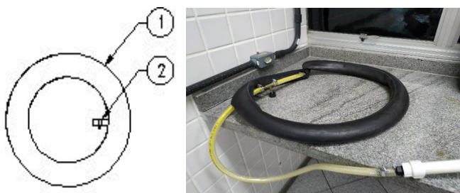
Figura 9.9 — Câmara de ar aro 18 para armazenagem do biogás
