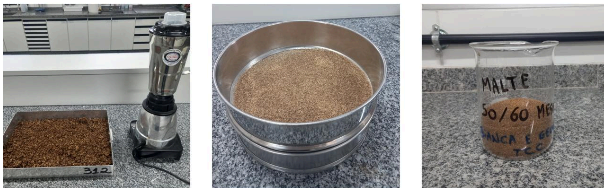
Figura 8 - Matéria prima seca, moída, peneirada e mistura das retenções das peneiras de 50 e 60 mesh
