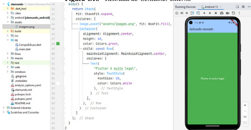
Figura 4.18 - Retirada do Container externo
