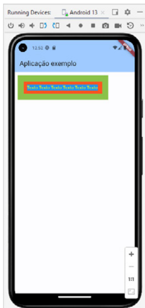
Figura 4.2 - Inserindo Container entre outro Container e Text
