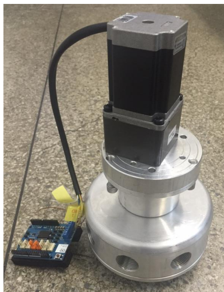
Figura 36 – Válvula cilíndrica montada com motor de passo
