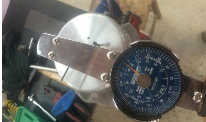
Figura 35 – Teste de torque com torquímetro de relógio.
