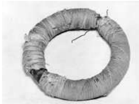
Figura 2 - Anel de ferro utilizado por Faraday na descoberta da indução eletromagnética.
