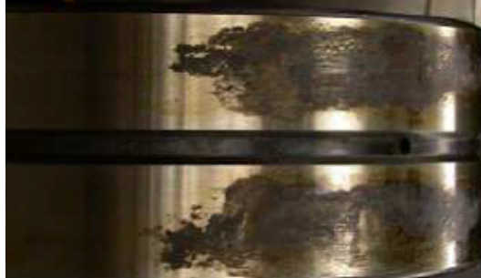
Figura 8 – Falhas devidos a assentos de eixos.
