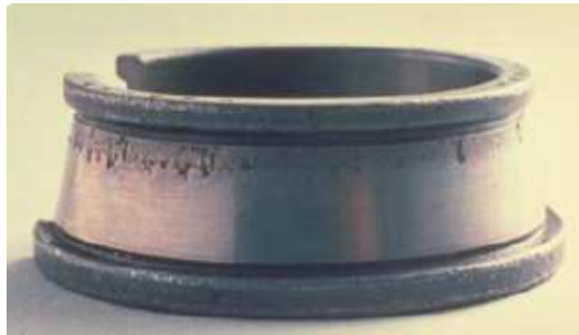
Figura 9 – Ajustes incorretos do eixo e da caixa de mancal
