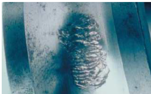
Figura 11 – Descascamento avançado causado pela fadiga.
