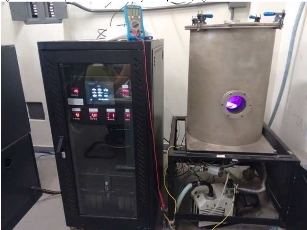
Figura 15 - Reator a plasma utilizado na redução dos pós TiO 2 -Mg.
