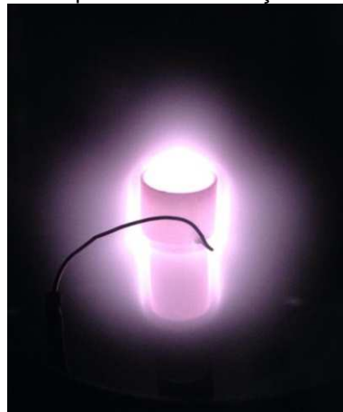
Figura 11 - Foto do cátodo oco durante o processo de redução.
