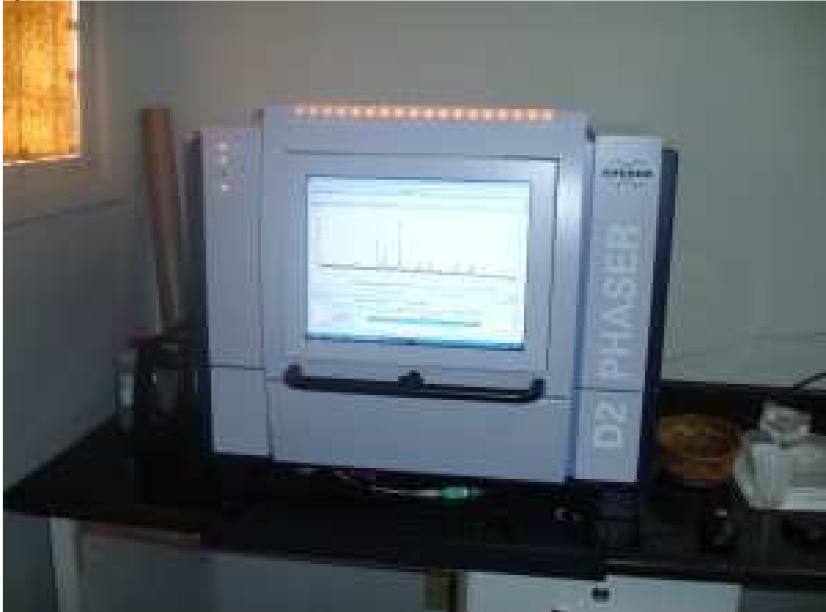
Figura 13 - Difratorômetro de Raios-X – Marca: Bruker – D2 Phaser.
