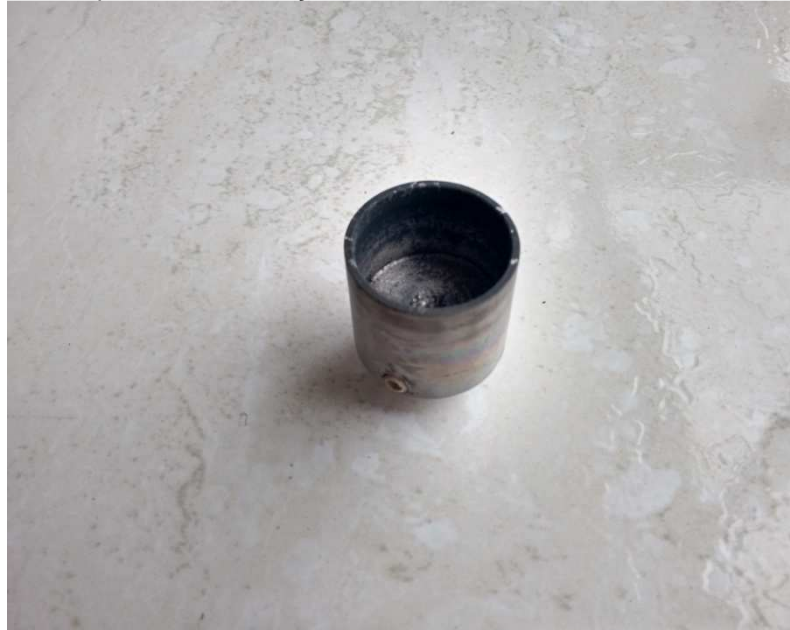
Figura 16 - Cátodo oco, após uma das reações realizadas.
