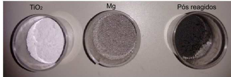
Figura 17 - Imagem mostrando da esquerda para direita os pós de \text{TiO}_2 , Mg e o produto da reação.
