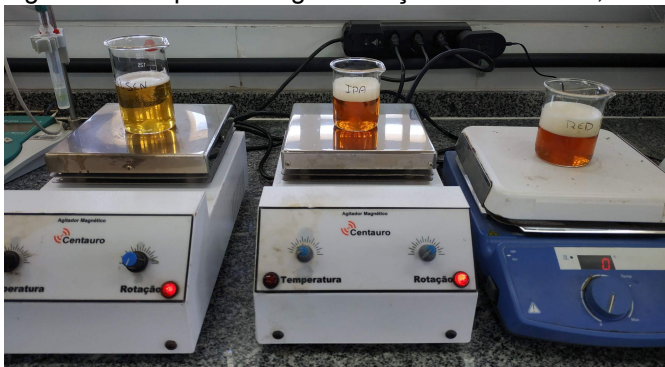
Figura IX - Etapa de desgaseificação - Amostras 1, 2 e 3
