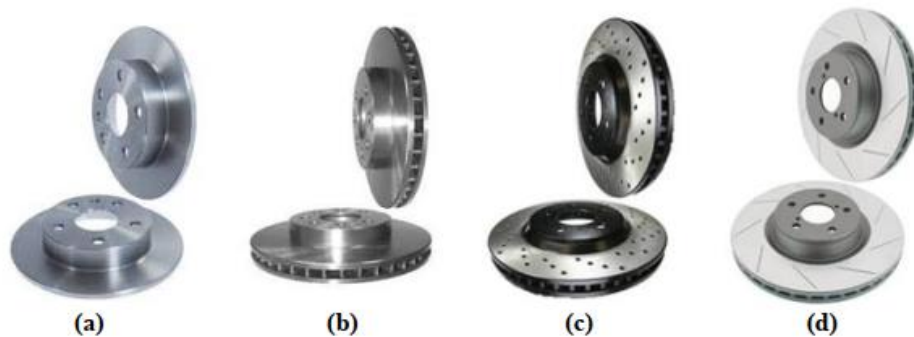
Figura 11 - Geometrias dos discos de freio: (a) Disco sólido (b) Disco Ventilado (c) Disco perfurado (d) Disco ranhurado.
