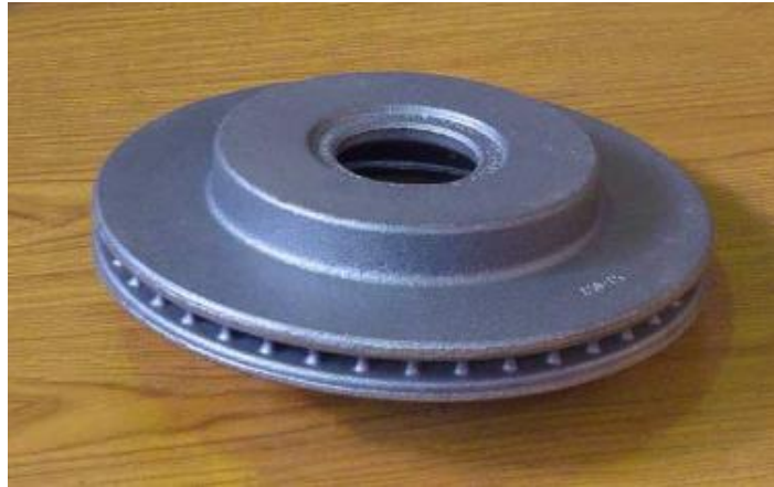
Figura 13 - Disco de freio ventilado, produzido em ferro fundido cinzento.
