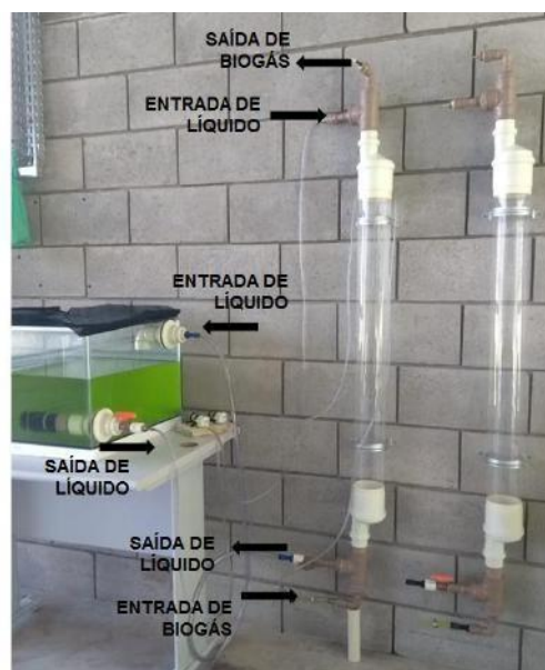
Figura 4. Fluxo do líquido e do biogás.
