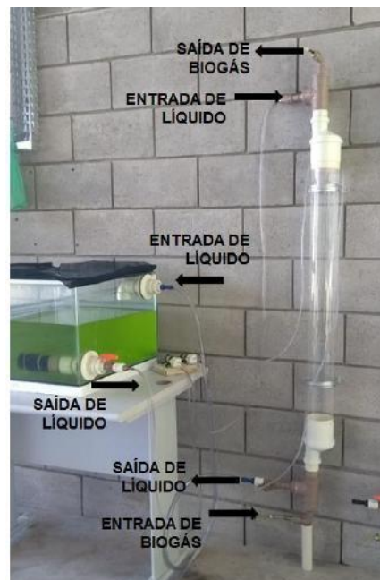
Figura 5. Circulação do líquido e do biogás.
