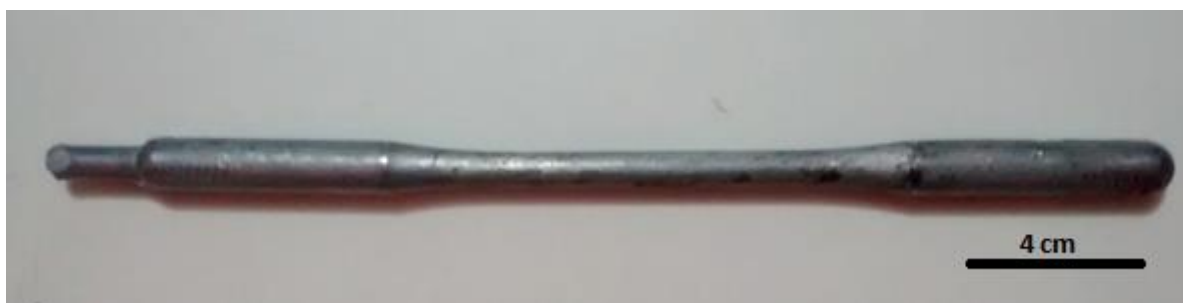
Figura 2 – Típico corpo de prova produzido através do processo de injeção (Die Casting)
