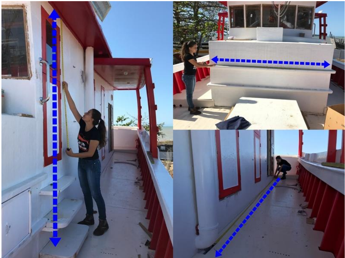
Figura 14 - Coleta das dimensões da casaria e da tina externa.
