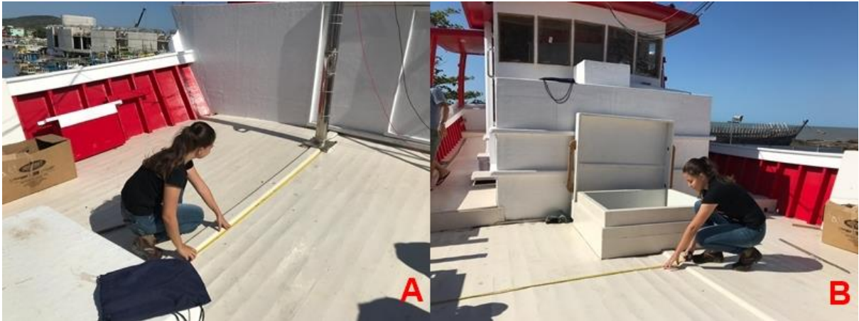
Figura 8 – Medição do comprimento e boca da embarcação.
