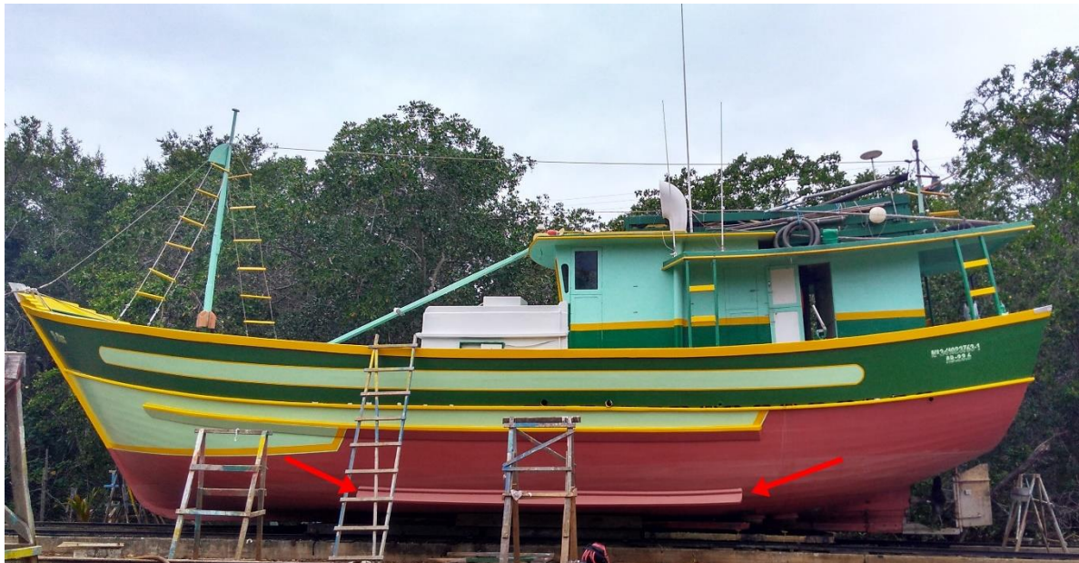
Figura 4 - Vista lateral de uma embarcação de pesca, destacado nas setas vermelhas a bolina.
