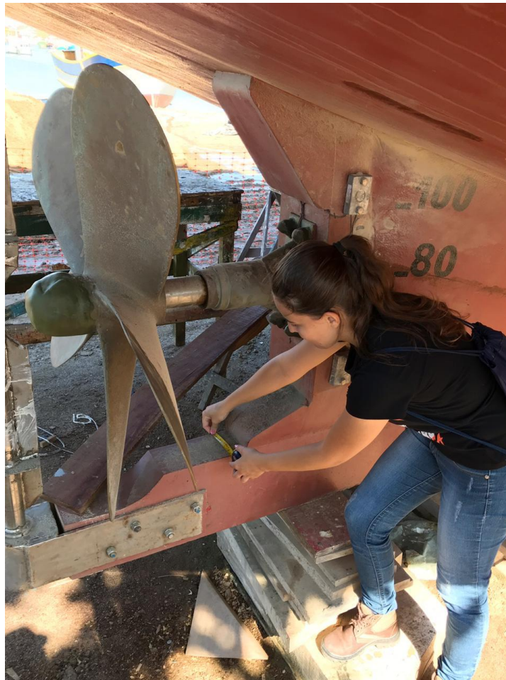
Figura 11 - Medição da largura da quilha da embarcação.
