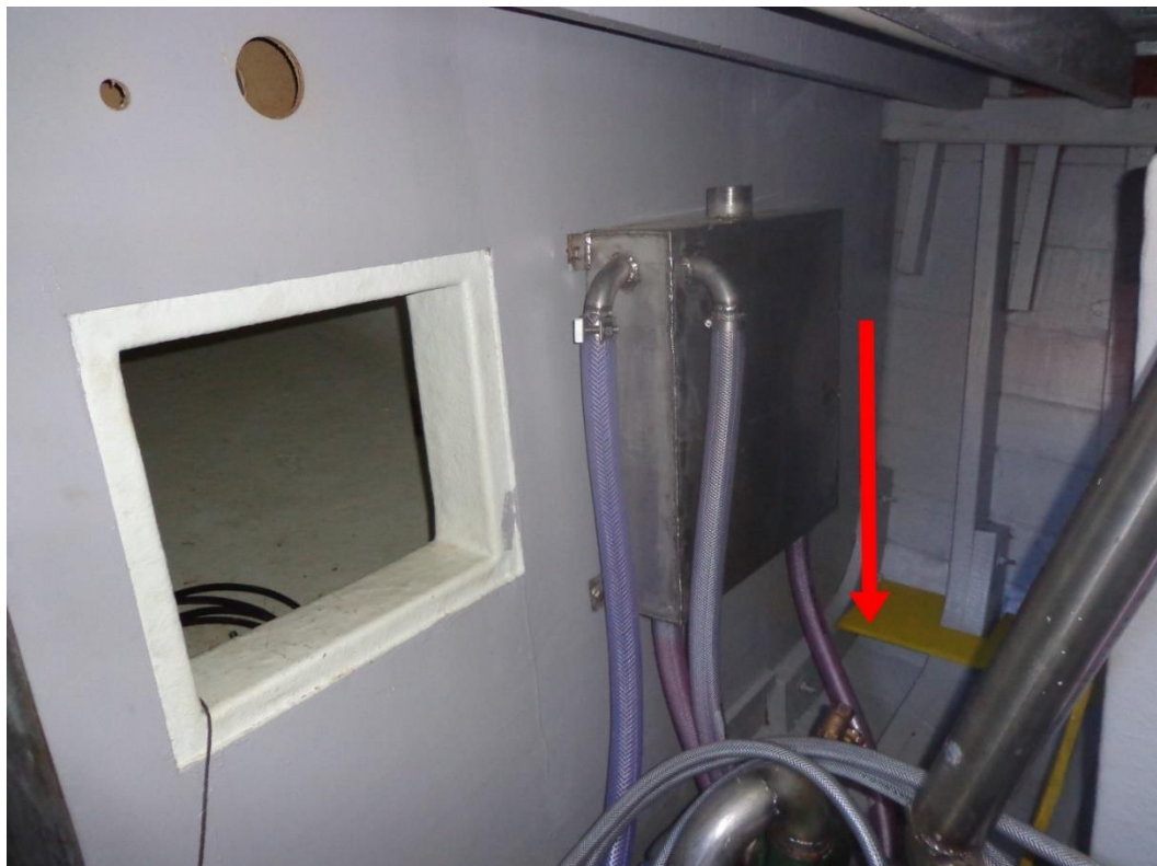
Figura 9 - Divisão da praça de máquinas com a tina interna.
