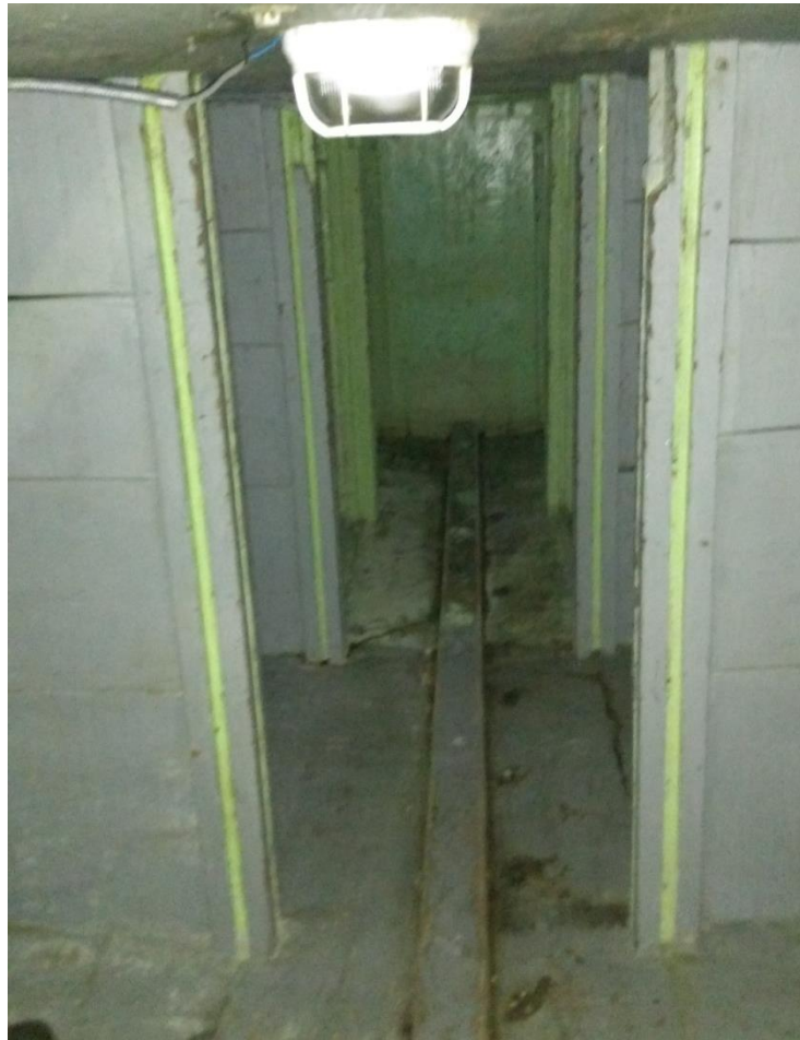
Figura 12 - Interior da urna de uma embarcação, com a divisão dos compartimentos sem as tábuas.
