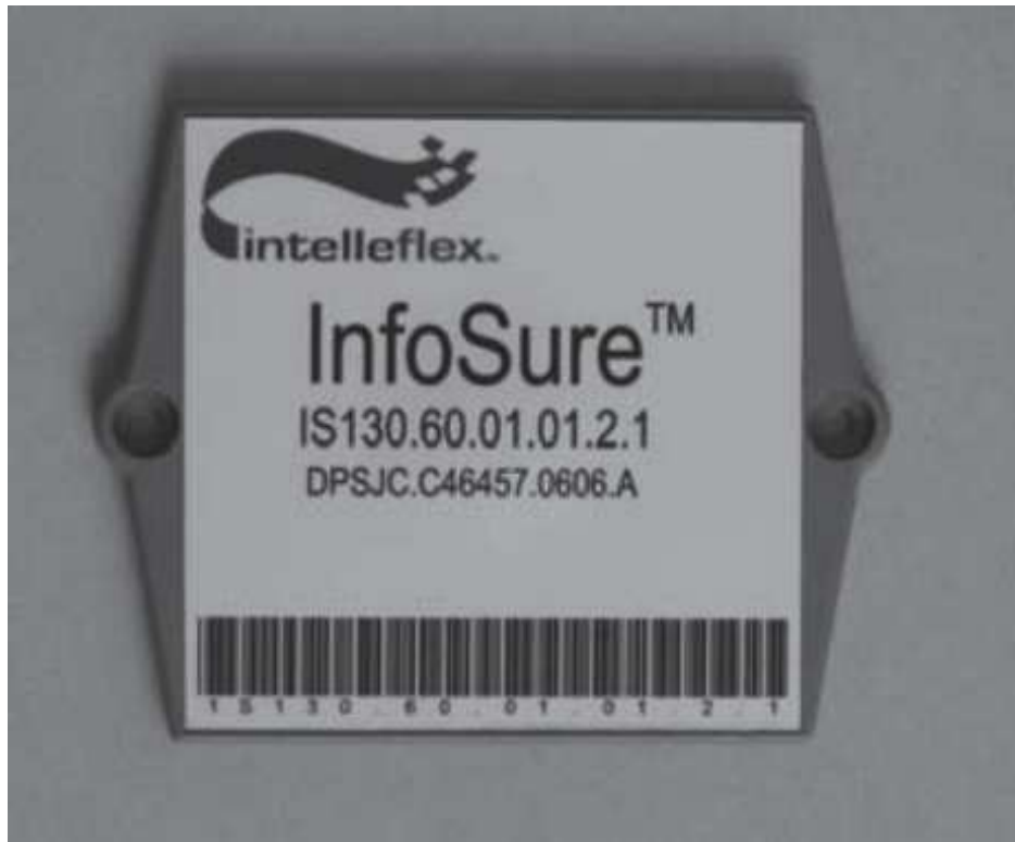
Figura 5 – Exemplo de tag RFID semi-passiva
