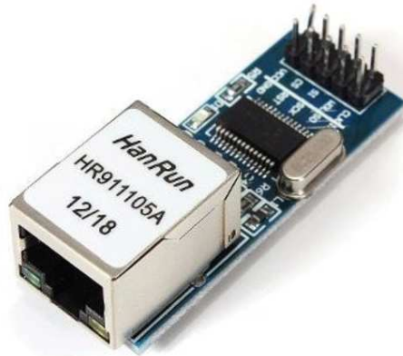
Figura 24 – Módulo Ethernet ENC28J60
