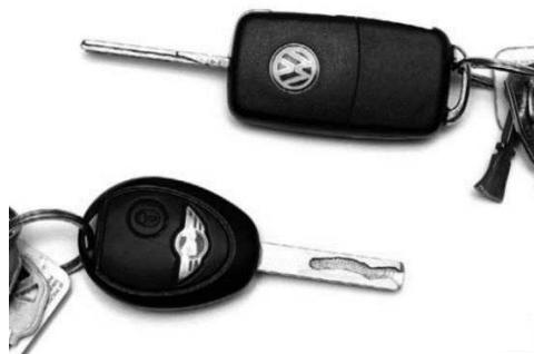
Figura 7 – Exemplo de chaves de automóveis com tags RFID LF embarcadas
