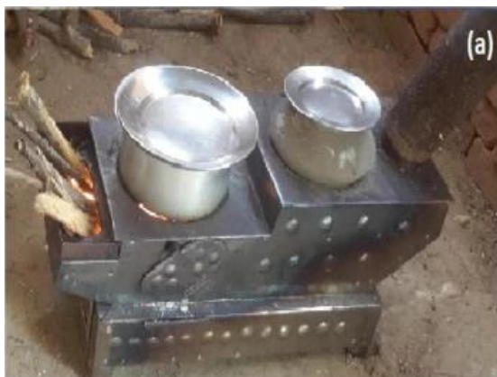
Figura 5 - Fogão a lenha de metal melhorado.
