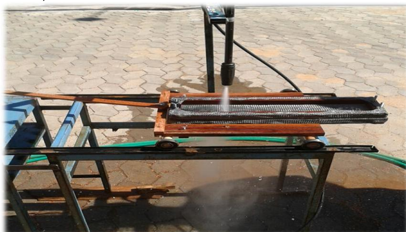
Figura 1: Aparelho utilizado para acoplar a máquina de pressão de água (Funcionamento).
