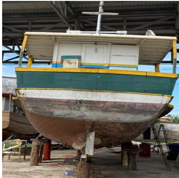
Figura 2 - Embarcação escorada para manutenção no estaleiro em Itaipava.
