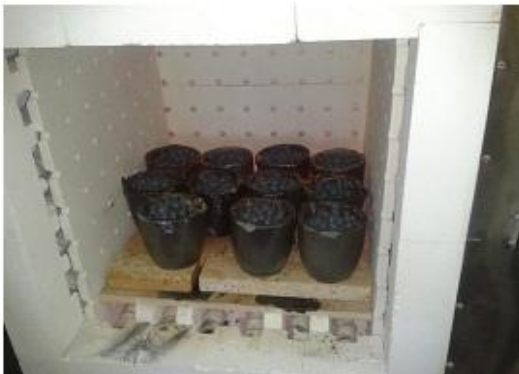
Figura 30 - Forno utilizado para queima das pelotas.
