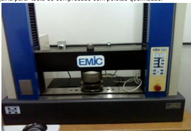
Figura 35 - Máquina para teste de compressão com pelotas queimadas.
