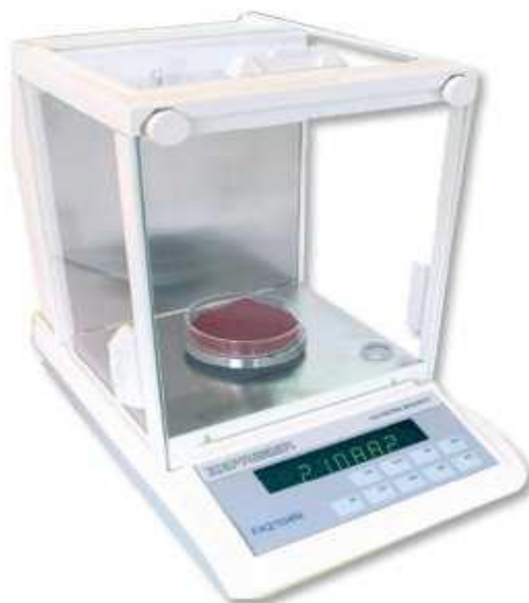
Figura 34 – Balança hidrostática - modelo SSR – 3000.
