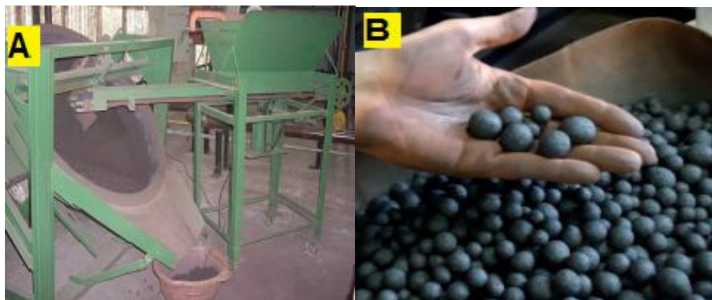
Figura 28 - Etapa de aglomeração. (a) equipamento em escala piloto, (b) pelotas produzidas.
