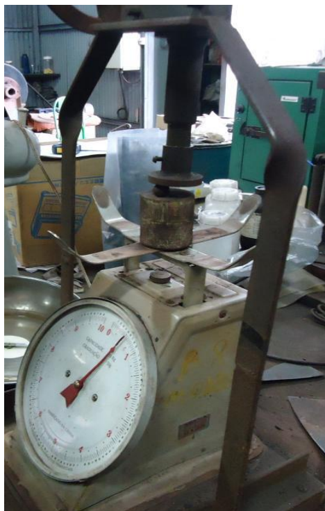
Figura 31 - Prensa utilizada para realizar o teste de compressão das pelotas verdes (cruas) e secas.
