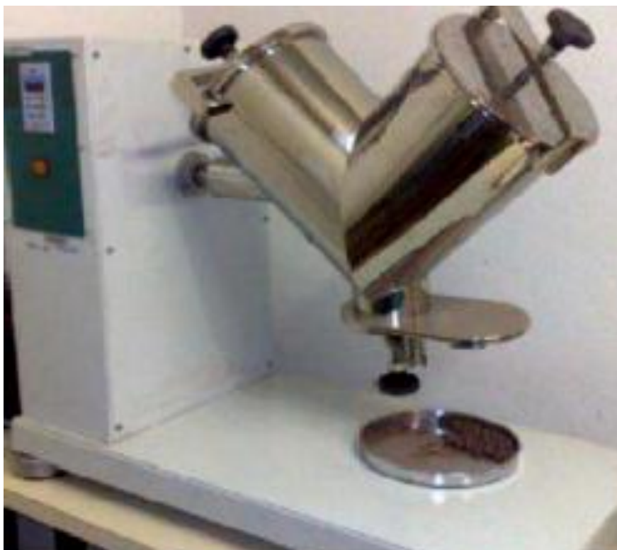
Figura 22 – Homogeneizador, usado na mistura das massas.
