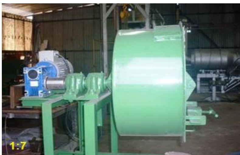
Figura 33 - Equipamento para ensaio de abrasão e tamboramento.
