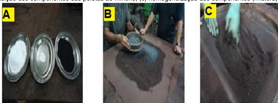
Figura 27 - Preparação da mistura a ser pelletizada. (a) resíduo de mármore, CMC e carvão, (b) adição dos componentes das pelotas ao minério, (c) homogeneização dos componentes (mistura).
