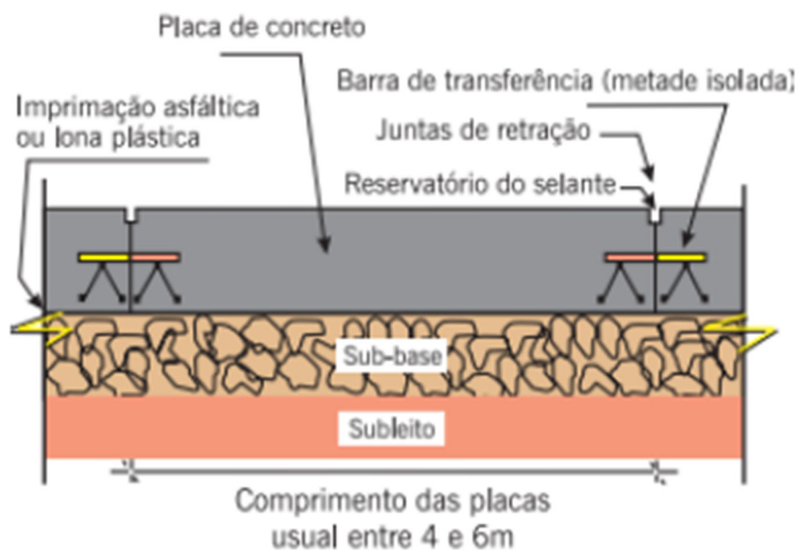
Figura 02 – Estrutura de um pavimento Rígido
