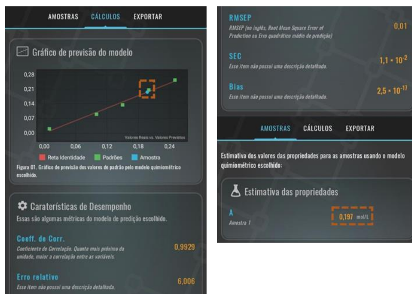
Figura 11. Resultados da regressão PLS para determinar concentração de \text{CuSO}_4 em água e previsão de uma amostra de concentração de 0,02 \text{ mol.L}^{-1} .
