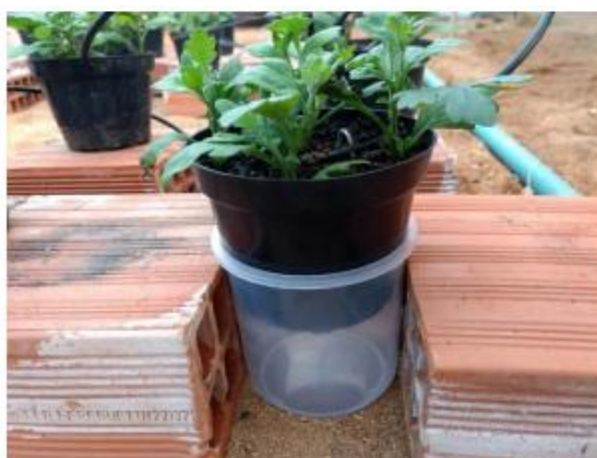
Figura 02: Lisímetro de drenagem montado através dos vasos de crisântemo.
