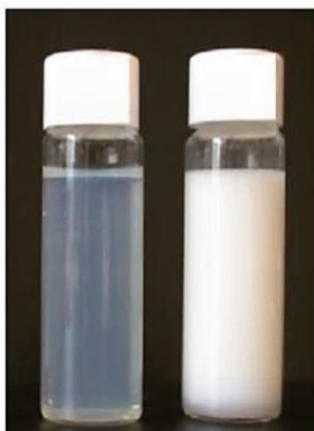
Figura 4 - Aspecto da nanoemulsão (à esquerda) e de uma emulsão convencional (à direita).
