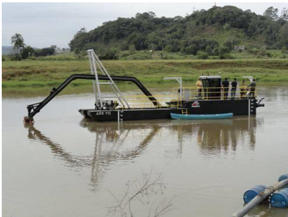
Figura 6 – Draga de extração de areia em leitos de rios
