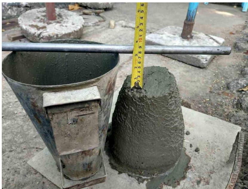
Figura 5 - Medição do abatimento ( slump test )
