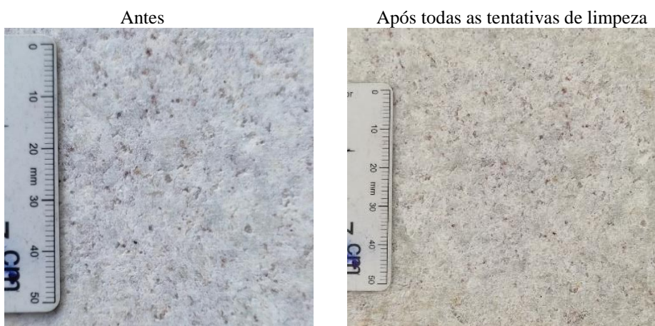
Figura 13: Ensaio de Manchamento com Cloro no Material Branco Itaúnas sem aplicação do ácido
