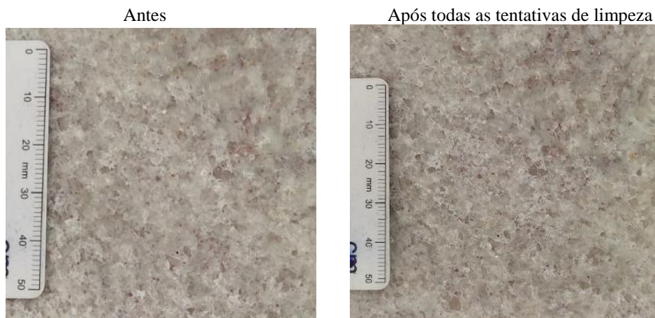
Figura 10: Ensaio de Manchamento com Suco de Limão no Material Branco Itaúnas com aplicação do ácido
