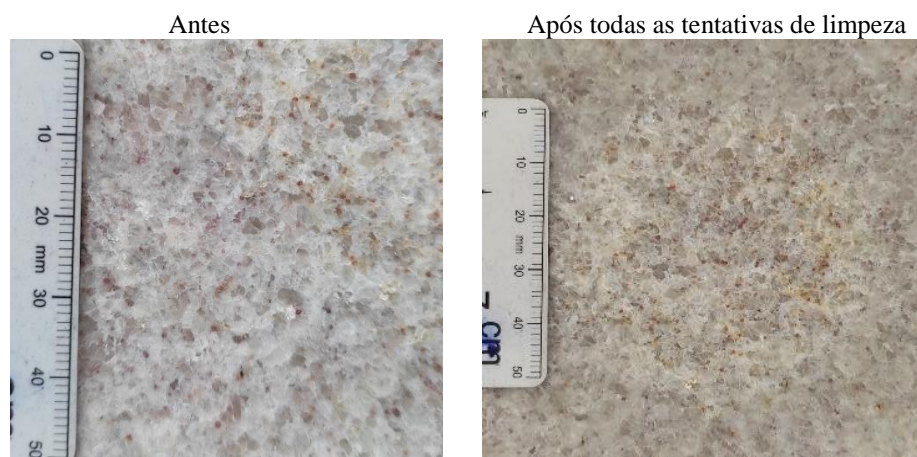
Figura 12: Ensaio de Manchamento com Cloro no Material Branco Itaúnas com aplicação do ácido
