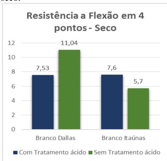
Gráfico 2: Resultados do Ensaio de Resistência a Flexão em quatro pontos á seco.
