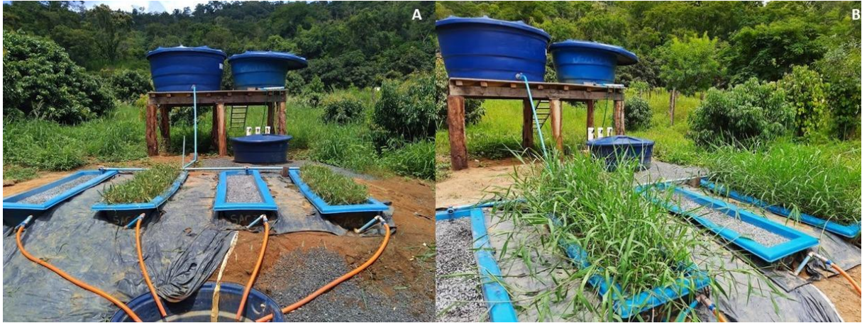
Figuras 4- Sistema alagado construído vegetado com capim-Tangola em funcionamento. (A) SAC vegetado após corte de uniformização; (B) Desenvolvimento do capim-Tangola aos 60 dias de funcionamento do sistema.
