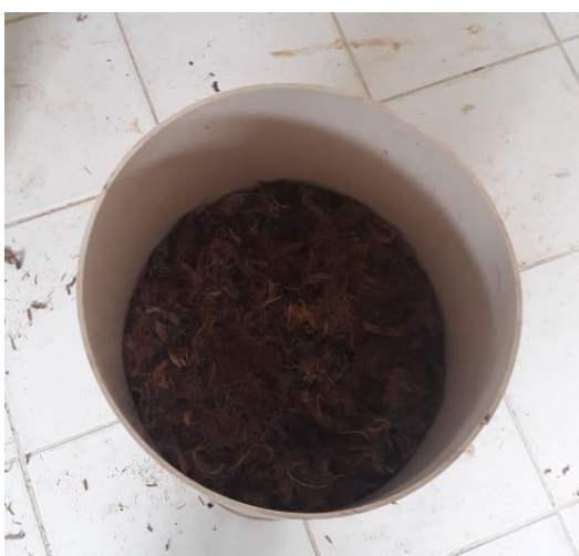
Figura 3 – Acondicionamento do engaço de bananeira no filtro orgânico.
